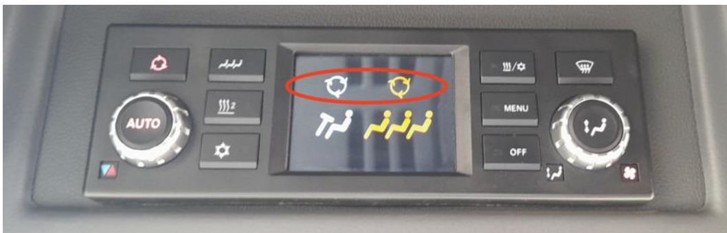
Figura 14. Posición de las compuertas de circulación aire, aire exterior/aire recirculante 100% cerradas.
