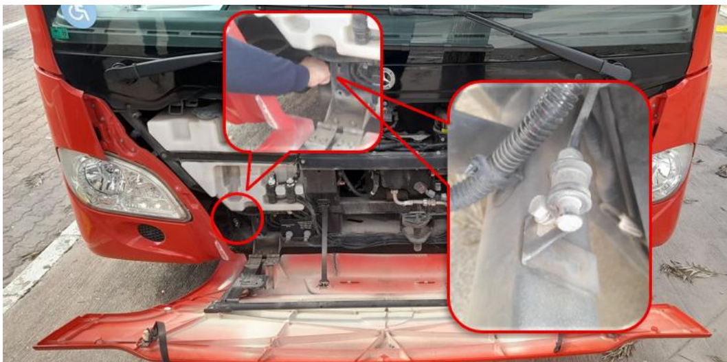
Figura 12. Sensor de “Temperatura externa (°C)”
