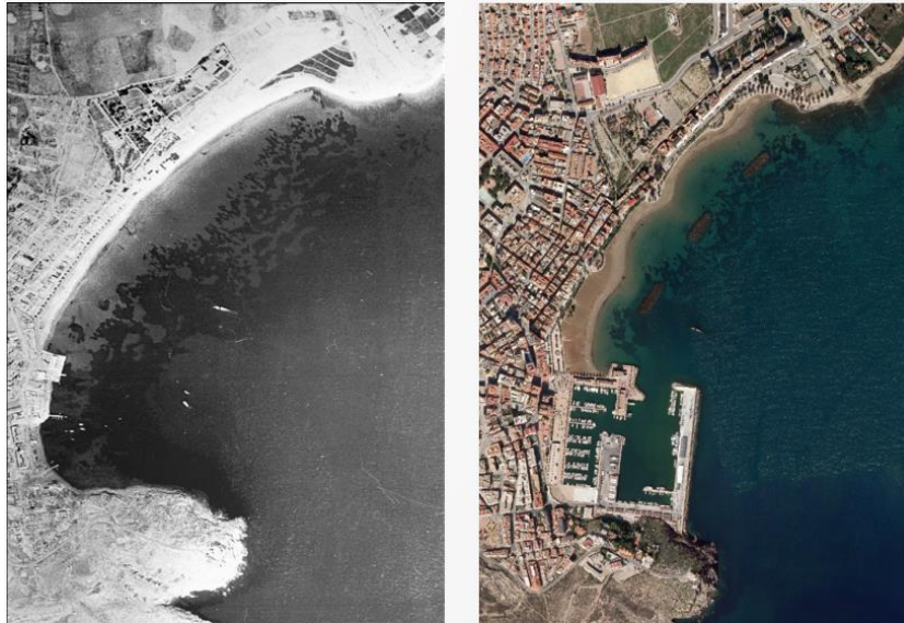
Figura 2: El impacto de diques superficiales sobre las praderas marinas. Puerto de Mazarrón (Murcia) en la década de 1950 (izda.) y en la actualidad (dcha.; ortofoto de 2009).
