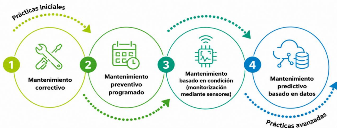
Figura 2: Evolución de las estrategias de mantenimiento hacia el Mantenimiento 4.0 basado en monitorización y análisis de datos.
